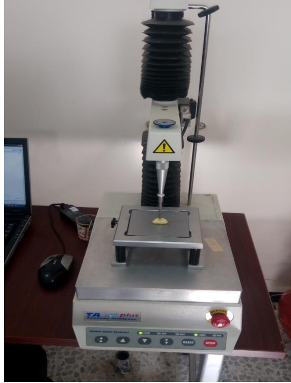
الصورة (3) جهاز تحديد القوام المستخدم في الدراسة
