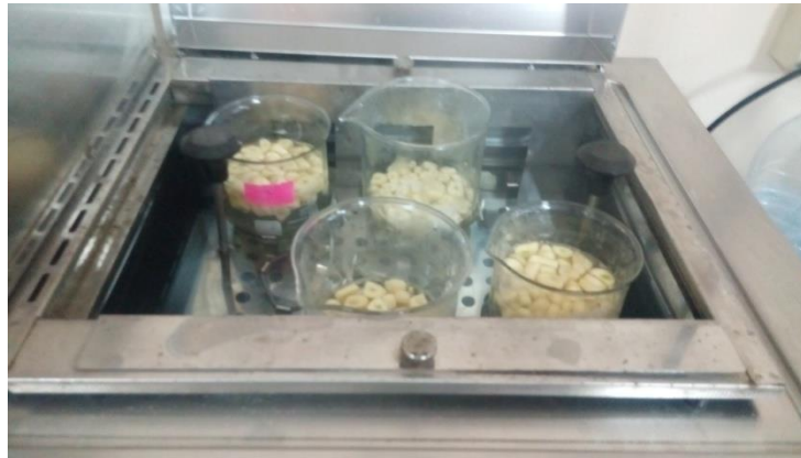
الصورة (5) نماذج من العينات أثناء عملية التجفيف الأسموزي
