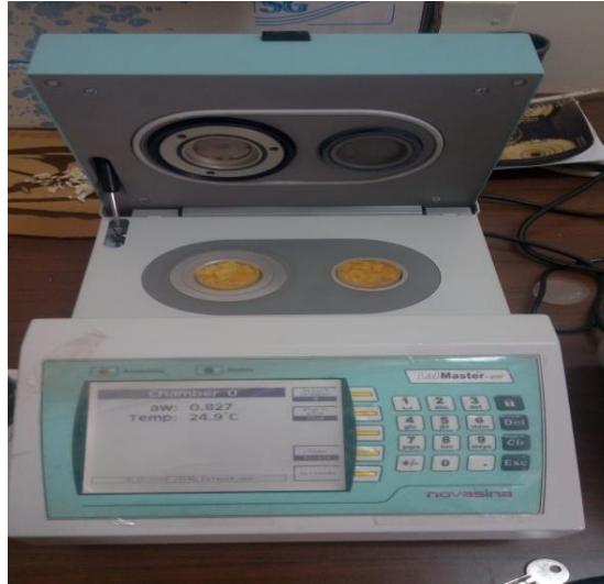
الصورة (2) جهاز تحديد فعالية الماء المستخدم في الدراسة
